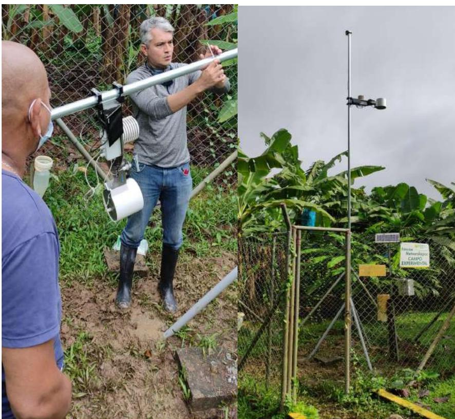
**Figura 6.** Instalación estación agrometeorológica en el campo experimental y demostrativo Ramiro Jaramillo Sossa.
