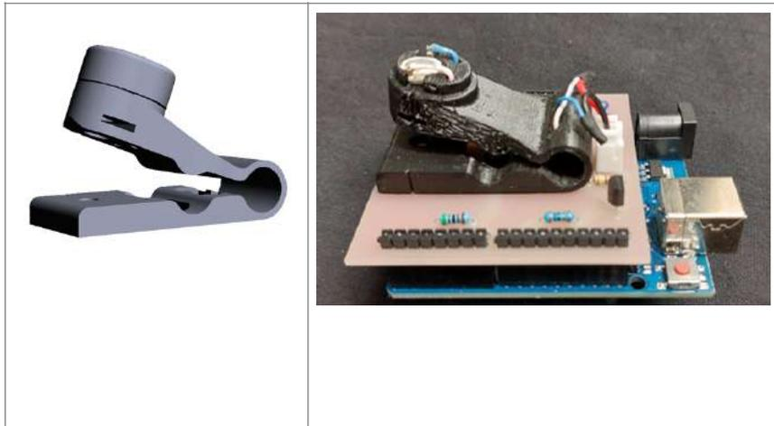
**Figura 2.** A. Diseño 3D de palanca, B. Dispositivo de medición de N ensamblado.
