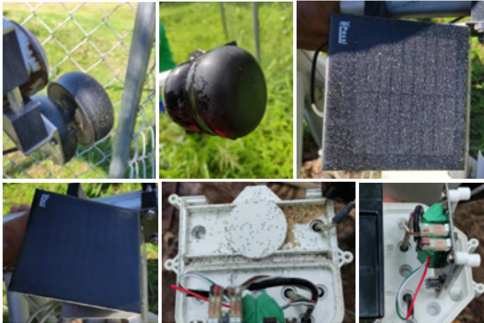
**Figura 3.** Mantenimiento de equipos red agrometeorológica del sector bananero
