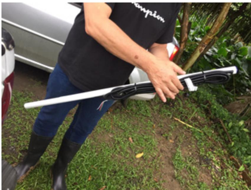
**Figura 1.** Sensor de humedad de suelo Drill & Drop Sentek en cuatro fincas de la zona bananera de Urabá.
